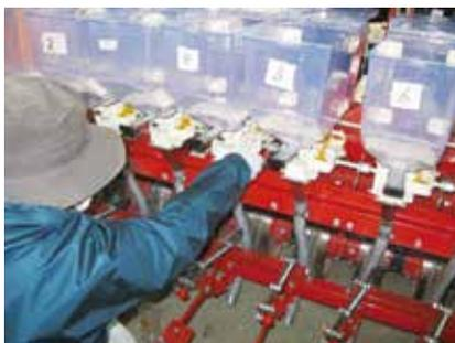
写真1 肥料落下量の調整
